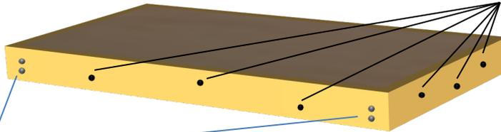
Bohrungen zur Befestigung der Beine
